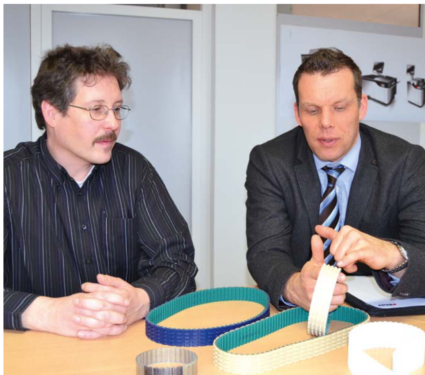
Alle Zahnriemen für die Schneidmaschinen auf einen Blick: Der weiße ist doppelt verzahnt und dient als Hauptantrieb. Der kleine silberne koppelt die Riementriebe der zwei beschichteten Zahnriemen. Volker Helle (links) und Rainer Müller kennen alle Details dieser ausgeklügelten Zahnriemen.
