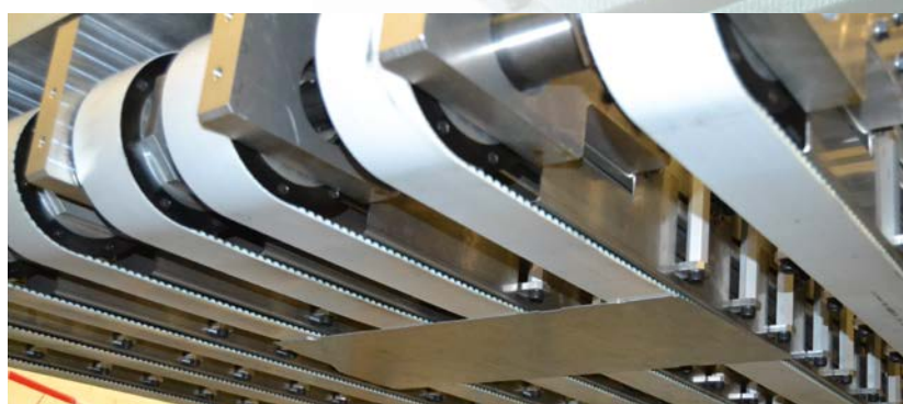
Die Dauermagnete sind mit einer Hebelmechanik synchron nach oben verschiebbar und lassen die Platinen definiert fallen.
